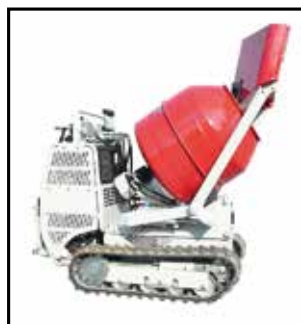
Hormigonera de 250 l con pala autocargable
