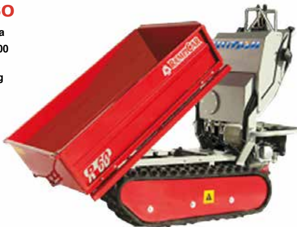
VERSION CON CAJA "TIPO AGRÍCOLA" DESCARGA HIDRAULICA FRONTAL
