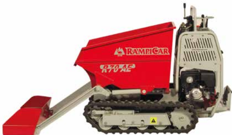
VERSION CON TOLVA "TIPO DUMPER" Y CON PALA AUTOCARGABLE DESCARGA HIDRAULICA FRONTAL
