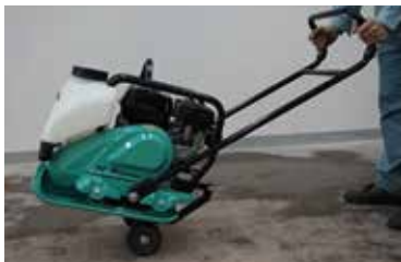
El modelo MVC-T90 HC incorpora filtro ciclón y carro con ruedas
