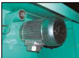
Motor independizado de la parte inferior de la mesa.
