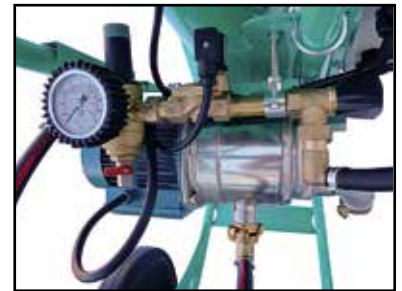
Bomba de agua autocebante con carcasa de acero inoxidable e impulsor de latón.
