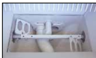
Válvula automática "S", para la salida y el retorno del material.
