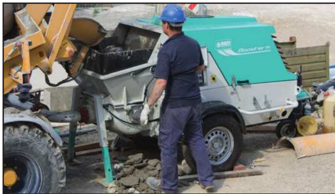
Alimentación para camión, hormigonera o autohormigonera
