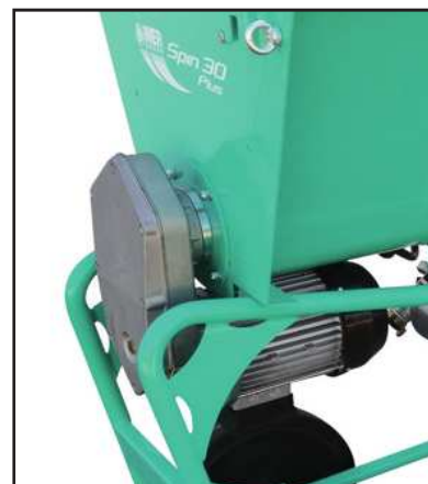
Transmite la potencia del motor a las palas de mezcla mediante un reductor con engranajes de acero tratado en baño de aceite. Con este sistema directo de transmisión, se garantiza unas prestaciones más elevadas, eliminándose las típicas averías que se producen por el sistema de transmisión de la potencia mediante correas.
