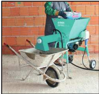
Mezcla morteros ensacados con gran rapidez (15/18 l/min.)
