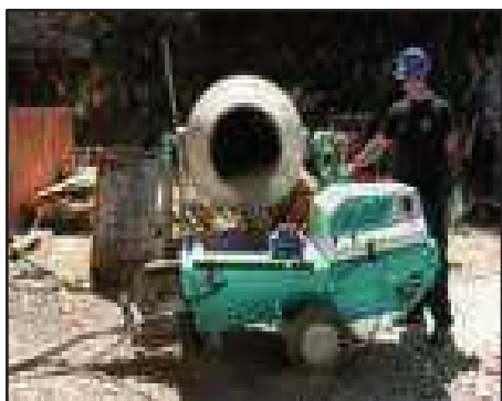
Alimentada por una hormigonera que principalmente es utilizada para realizar mortero tradicional. (Hormigonera IMER modelo SYNTESI)
