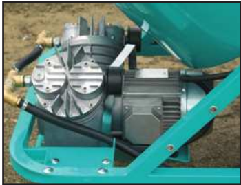
Compresor eléctrico de membranas (original IMER)
