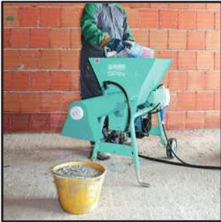
Mezcla morteros ensacados con gran rapidez (15/18 l/min.)
