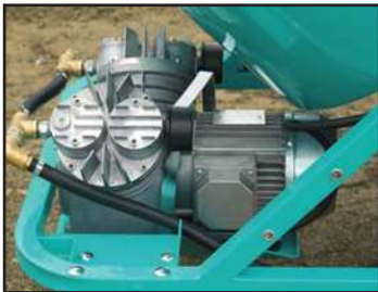
Compresor eléctrico de membranas (original IMER)
