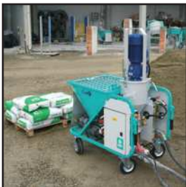
Con un potente motor eléctrico trifásico, que garantiza un alto rendimiento en la mezcla y proyección de morteros premezclados, yesos y monocapas
