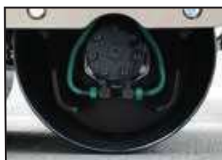
Protección de los latiguillos hidráulicos contra daños producidos por piedras.
