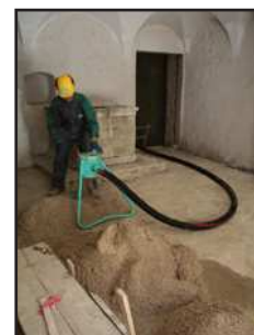
Caballete/trípode para recepción y reparto demorteros y áridos en planta. Se suministra siempre de serie.
